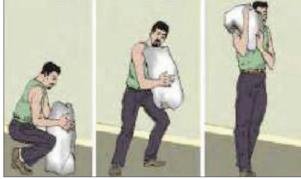
Görsel 3.22: Yükün doğru kaldırılması ve indirilmesi
