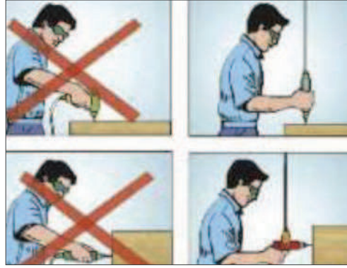
Görsel 3.25: El aletlerinin çalışılan alana göre yanlış ve doğru kullanımları
