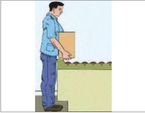
Görsel 3.15: Çalışan için üst vücut ve ayak mesafesine uygun bant yüksekliği
