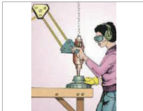
Görsel 3.24: El aletlerinin ağırlığının azaltılması
