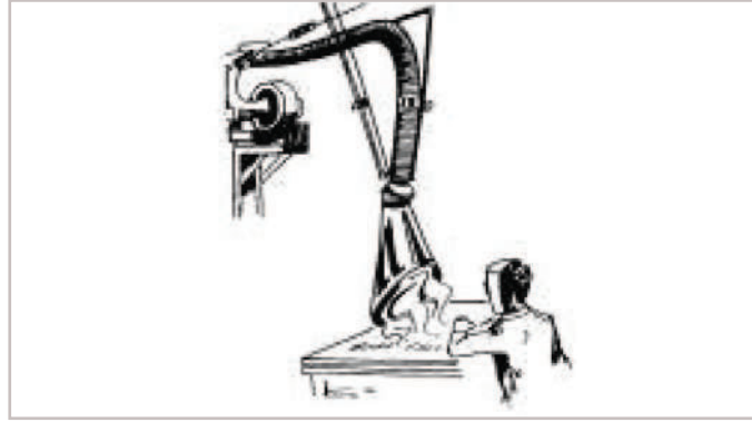
Görsel 3.47: Lokal havalandırma örneği
